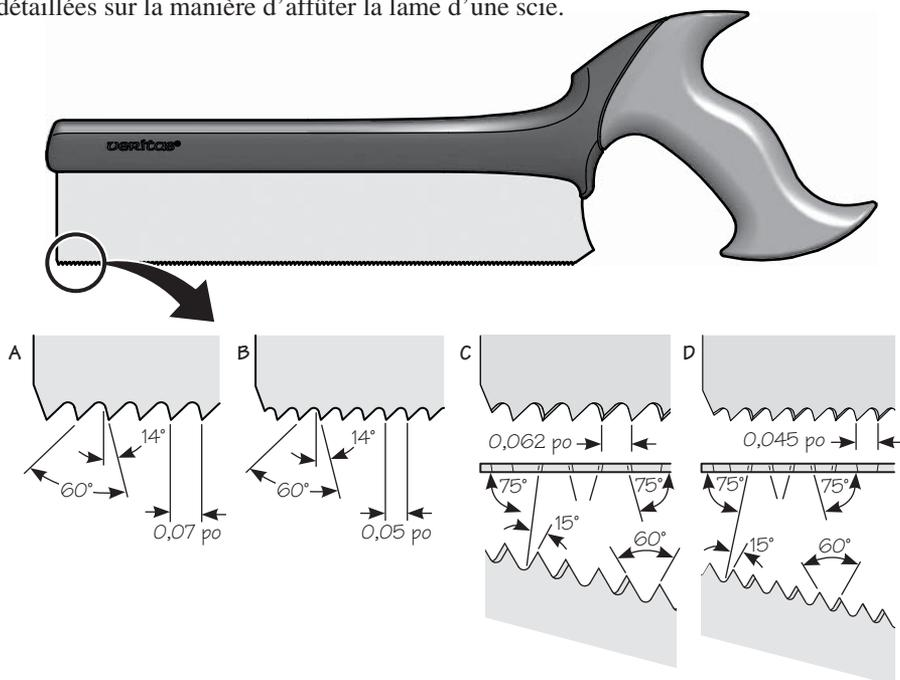
**Figure 1 : Géométrie des dents de la scie à queue d'aronde standard (A), de la scie à queue d'aronde à dents fines (B), de la petite scie à tronçonner (C) et de la petite scie à tronçonner à dents fines (D).**
